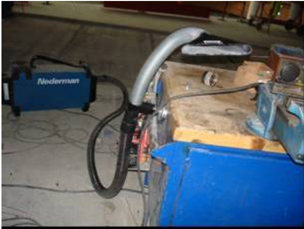
Bild 11 Placering av mobilt punktutsug som används vid svetsning på arbetsbänk. Man fäster magnet på bänkens sida
